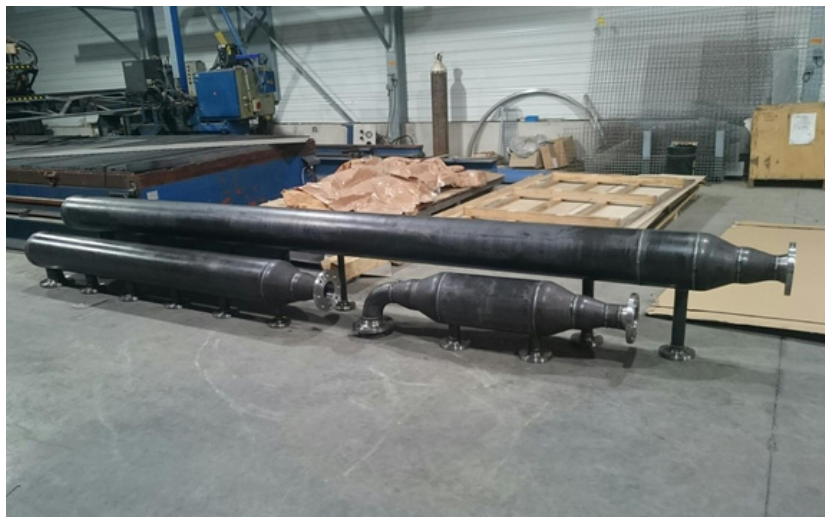
nourrice de distribution d'eau
